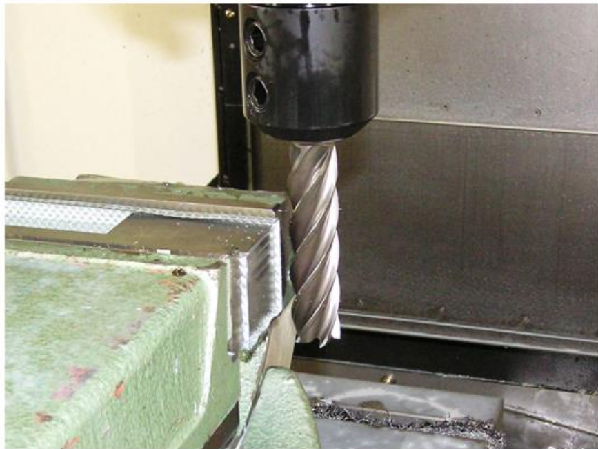
Obr. 1 Frézovanie koncov dlhých tlačných vzoriek
