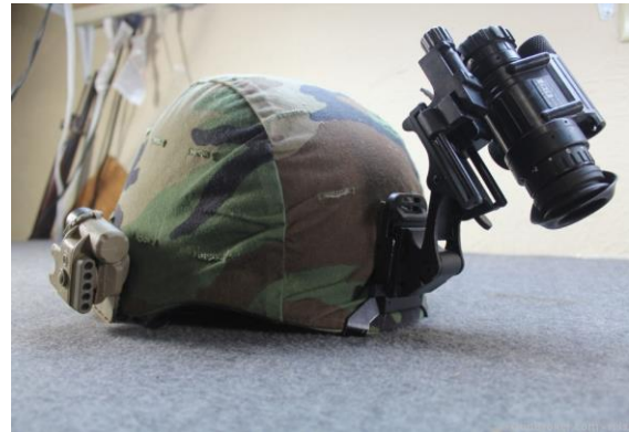
2000-obecnie: AN/PVS-14 Monocular Night Vision Device (gen. 3)
